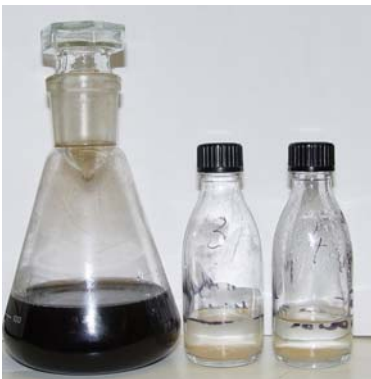
Abb. 5: Abwasserproben links: vor der Behandlung rechts: nach der Behandlung
